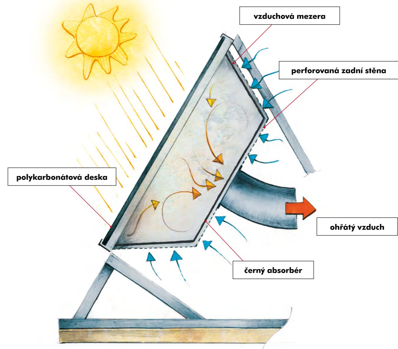
Obrázek 1. - Princip vzdušného solárního systému
